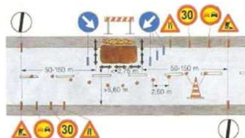
Lavori su strada urbana con restringimento della corsia a larghezza inferiore a 2,75m e larghezza della carreggiata disponibile maggiore di 5,60m
