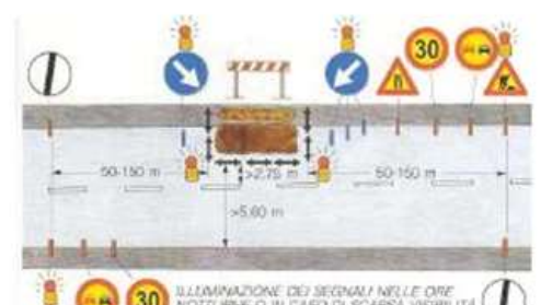
ILLUMINAZIONE DEI SEGNALE E DEI BARRIERE DI TESTA DELLE ZONE DI LAVORO In questi casi il segnale "Lavori" e la barriera di testa delle zone di lavoro devono essere integrati con apparati luminosi di colore rosso a luce fissa e lo sbaramento obliquo che precede eventualmente la zona di lavoro deve essere integrato con dispositivi a luce gialla lampeggiante.
