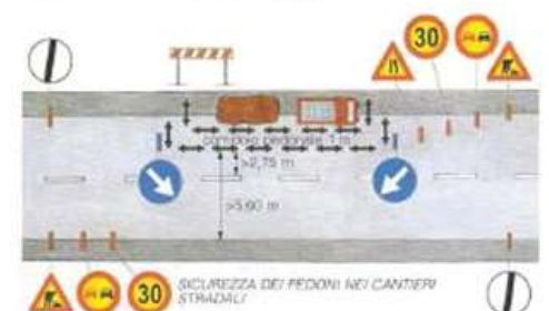
ILLUMINAZIONE DEI SEGNALE E DEI BARRIERE DI TESTA DELLE ZONE DI LAVORO In questi casi il segnale "Lavori" e la barriera di testa delle zone di lavoro devono essere integrati con apparati luminosi di colore rosso a luce fissa e lo sbaramento obliquo che precede eventualmente la zona di lavoro deve essere integrato con dispositivi a luce gialla lampeggiante.
